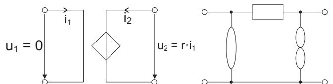
$$\mathbf{A} = \begin{bmatrix} 0 & 0 \\ \frac{1}{r} & 0 \end{bmatrix} \quad \mathbf{R} = \begin{bmatrix} 0 & 0 \\ r & 0 \end{bmatrix} \quad \mathbf{M} = \begin{bmatrix} 1 & 0 \\ 0 & 1 \end{bmatrix} \quad \mathbf{N} = \begin{bmatrix} 0 & 0 \\ -r & 0 \end{bmatrix}$$
