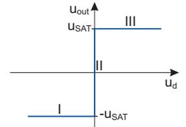
Operationsverstärker müssen immer über ihren invertierenden Eingang rückgekoppelt werden, da sich sonst eine Z-Kennlinie ergibt und der Arbeitspunkt somit nicht mehr eindeutig ist.
