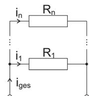
$$i_i = i_{\text{ges}} \cdot \frac{R_{\text{ges}}}{R_i} = i_{\text{ges}} \cdot \frac{G_i}{G_{\text{ges}}}$$
