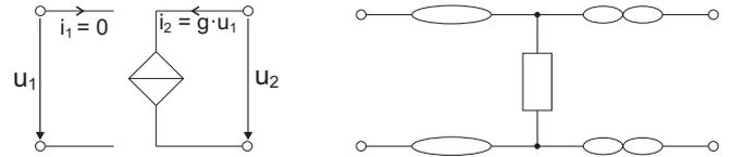
$$\mathbf{A} = \begin{bmatrix} 0 & -\frac{1}{g} \\ 0 & 0 \end{bmatrix} \quad \mathbf{G} = \begin{bmatrix} 0 & 0 \\ g & 0 \end{bmatrix} \quad \mathbf{M} = \begin{bmatrix} 0 & 0 \\ -g & 0 \end{bmatrix} \quad \mathbf{N} = \begin{bmatrix} 1 & 0 \\ 0 & 1 \end{bmatrix}$$
