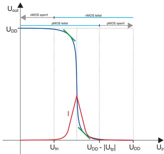
$v_{out}$  hat definierten Logikpegel, wenn gilt:  $|\frac{\partial v_{out}}{\partial v_{in}}| < 1$
