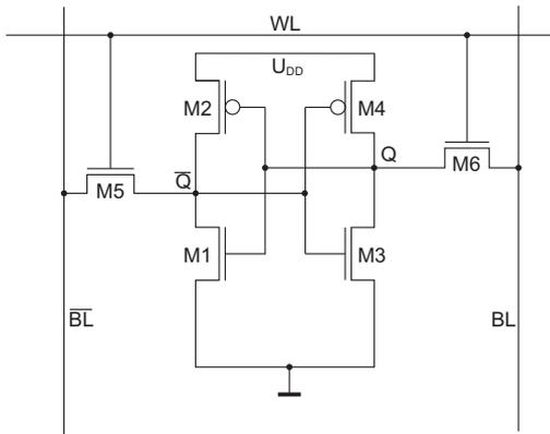
Die Transistoren M1 - M4 realisieren ein CMOS-Latch zur Speicherung einer "0" bzw. "1". Über die Transistoren M5 und M6 wird die Speicherzelle zum Lesen oder Schreiben ausgewählt.
