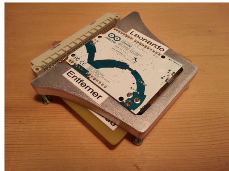
Abbildung 2.12: Hilfsmittel zum einfachen Entfernen des Leonardos von der Adapterplatine.
