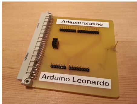
Abbildung 2.11: Adapterplatine für Arduino Leonardo.
