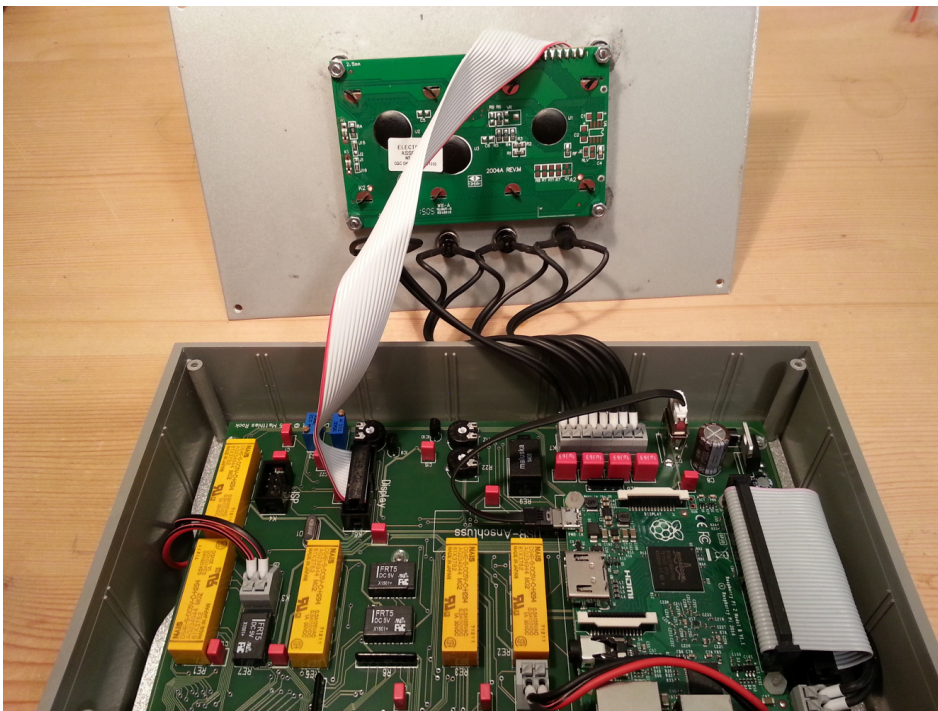
Abbildung 2.8: Aufbau von Testgerät (Gehäuse mit eingebauter Elektronik).
