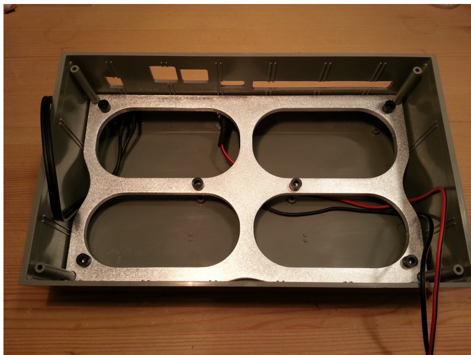
Abbildung 2.7: Aufbau von Testgerät (Gehäuse mit Platinen-Halterung).
